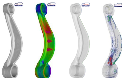
Рис. 1. Трехмерные данные КТ с анализом пористости и отклонений поверхности.
